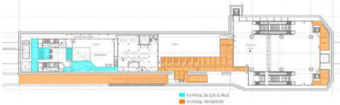
Ilustración 57 Pintura en techos - vestíbulo
