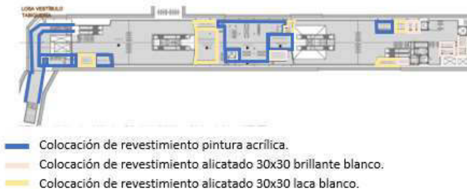
Ilustración 37 Tabiquería nivel losa de vestíbulo.
