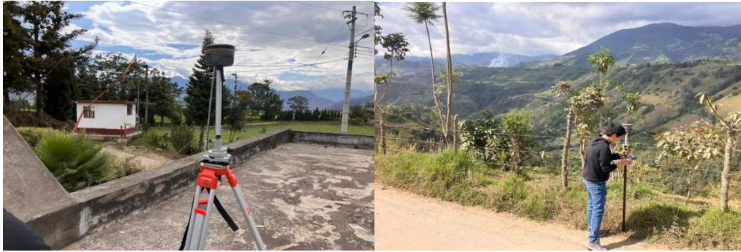
Foto 1: Replanteo de sitio
